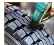
Recauchutado de neumáticos Recauchutagem de pneus
